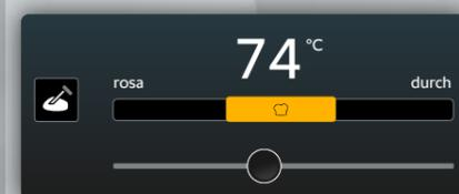
Der integrierte Kerntemperaturfühler erkennt mit seinen sechs Messpunkten Produktgröße und -menge. So wird die gewählte Kerntemperatur exakt erreicht und das Wunschergebnis gewährleistet.
